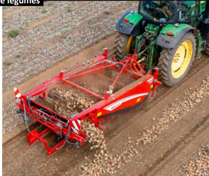
produit. Pour rendre le ramassage ultérieur plus efficace, une bande de dépose transversale est disponible. Cette bande peut être utilisée pour enrichir l'andain ou pour créer des voies d'arrachage (« système d'arrachage enrichi »).
