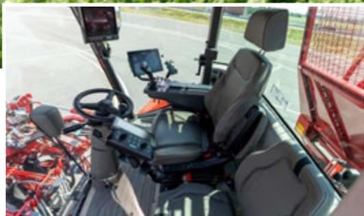
Le nouveau « Speedtronic-Cruise » commande automatiquement la vitesse de travail, exclusif sur le marché, en combinaison avec le Speedtronic afin d'assister le chauffeur à exploiter tout le potentiel de sa REXOR. Grâce au boîtier de commande supplémentaire ISOBUS IBX 200, le conducteur dispose d'une commande pour le processus de déchargement sur l'accoudoir gauche.
