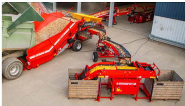
sont notamment utilisées pour les cultures sensibles. La trémie de réception RH 24-60 S est équipée d'un démêleur d'oignons, d'un tapis de présentation (bande de transfert entre fond de trémie et pack de rouleaux), ainsi que de rouleaux lisses en acier.
