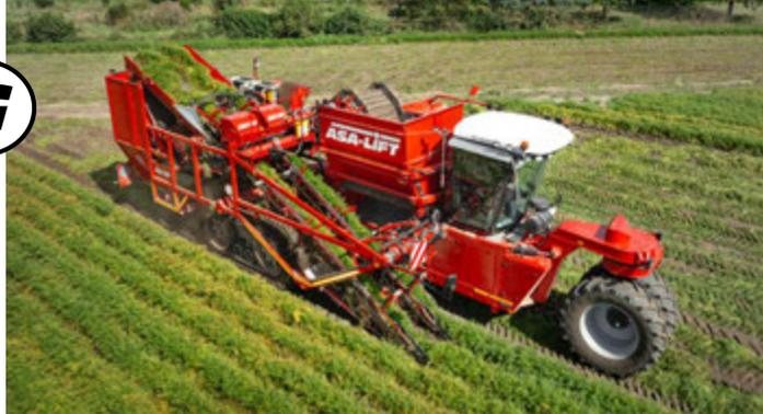
tage particulier est la sécurité de la récolte, qui est un point décisif. Les longues courroies d'arrachage offrent suffisamment de place pour les nettoyeurs de racines, ce qui permet de nettoyer efficacement la terre adhérente. Cette machine est donc également adaptée à la récolte à destination de chambres froides.
