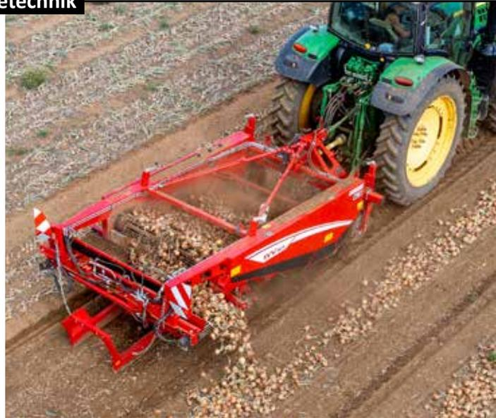
spätere Aufsammeln effizienter zu gestalten, steht ein Querablageband zur Verfügung. Dieses kann zum Anreichern des Schwades oder zum Schaffen von Anrodegassen genutzt werden.
