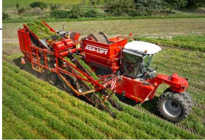
Die langen Klemmbänder bieten ausreichend Platz für Wurzelreiniger, sodass die anhaftende Erde effektiv abgereinigt werden kann und diese Maschine somit auch für die Ernte von Lagerware geeignet ist.
