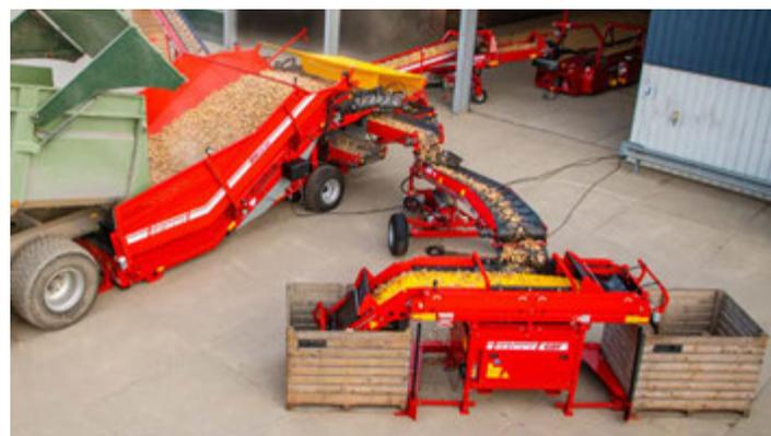
anderem für empfindliche Kulturen eingesetzt wird. Der RH 24-60 S ist mit einer Zwiebelhaspel, einem Präsentierband (Übergabeband zwischen Bunkerboden und Walzenpaket) und Stahl-Glattwalzen ausgestattet.
