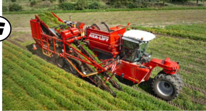
Vorteil ist die Erntesicherheit, die vielerorts einen ausschlaggebenden Punkt darstellt. Die langen Klemmbänder bieten ausreichend Platz für Wurzelreiniger, sodass die anhaftende Erde effektiv abgereinigt werden kann und diese Maschine somit auch für die Ernte von Lagerware geeignet ist.
