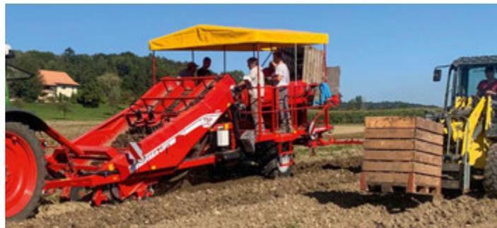
bändern befindliche Produktband. Von dort gelangen die Süßkartoffeln in die Kiste, welche wiederum angewinkelt ist, um eine möglichst schonende Ablage zu realisieren. Neben dem Einsatz in Süßkartoffeln ist diese Maschine auch für die Ernte von anderen empfindlichen Hackfrüchten einsetzbar.
