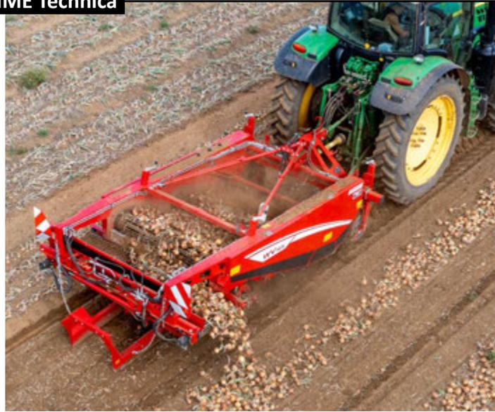
Zwischenbunker konfiguriert werden. Um das spätere Aufsammeln effizienter zu gestalten, steht ein Querablageband zur Verfügung. Dieses kann zum Anreichern des Schwades oder zum Schaffen von Anrodegassen genutzt werden.
