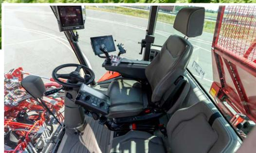
Новая система Speedtronic-Cruise впервые активно управляет приводом движения свеклоуборочного комбайна и обеспечивает в комбинации с системой Speedtronic для транспортирующего и очищающего устройств максимально эффективный рабочий день. Устройство управления ISOBUS IBX 200 на левом подлокотнике является дополнительным устройством управления процессом перегрузки для водителя.
