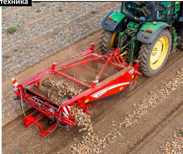
использован для укладки урожая в валок или для создания технологической колеи для последующей уборки урожая по методу "обогащения".
