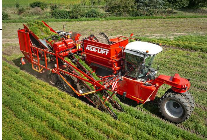
является решающим фактором. Длинные теревильные ремни обеспечивают достаточное пространство для пальчиковых очистителей корнеплодов, что позволяет эффективно удалять налипшую почву, благодаря чему эта машина также подходит для уборки урожая, предназначенного для закладки на хранение.
